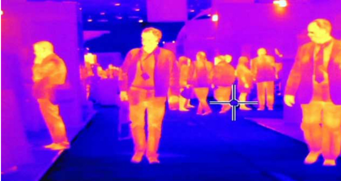
Figura 8: Si noti come il corpo di una persona, con temperatura quindi notoriamente maggiore rispetto all'ambiente, emetta un maggior valore di radiazioni.
